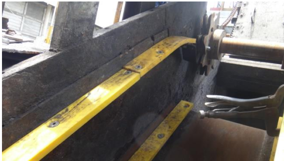
รูปที่ 10.36 การแก้ไข Conveyor Casing, Chain และ รางรับสายพาน ที่ชำรุดสึกเสียหาย
