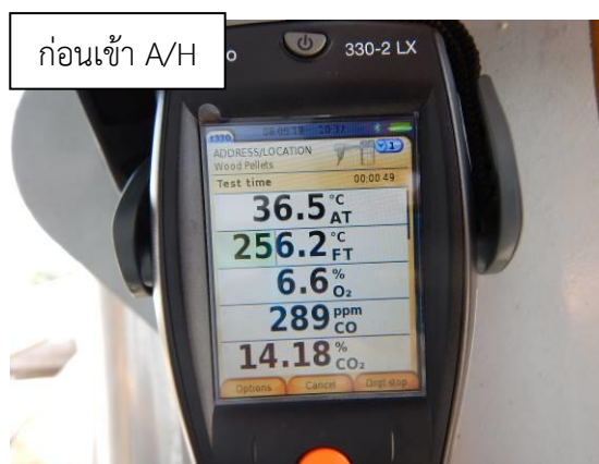
รูปที่ 4.15 การติดตั้งเครื่องวัดก๊าซไอเสียของหม้อน้ำ
