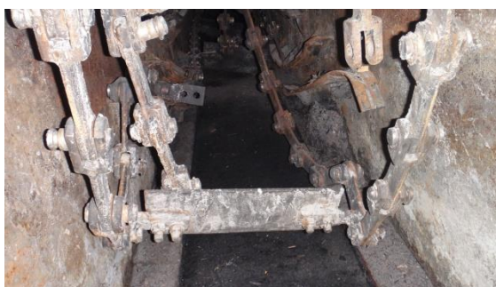
รูปที่ 10.34 การแก้ไข Chain, Flight Bar ของ Wet Ash Chain Conveyor ที่ชำรุด
