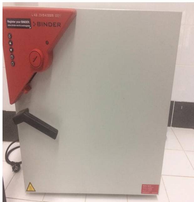
รูปที่ 2.48 ตู้อบลมร้อน ใช้ไล่ความชื้นเชื้อเพลิง เพื่อหาน้ำหนักก่อน และน้ำหนักหลังการอบ มาคำนวณหาความชื้นเชื้อเพลิงแบบ Moisture balance
