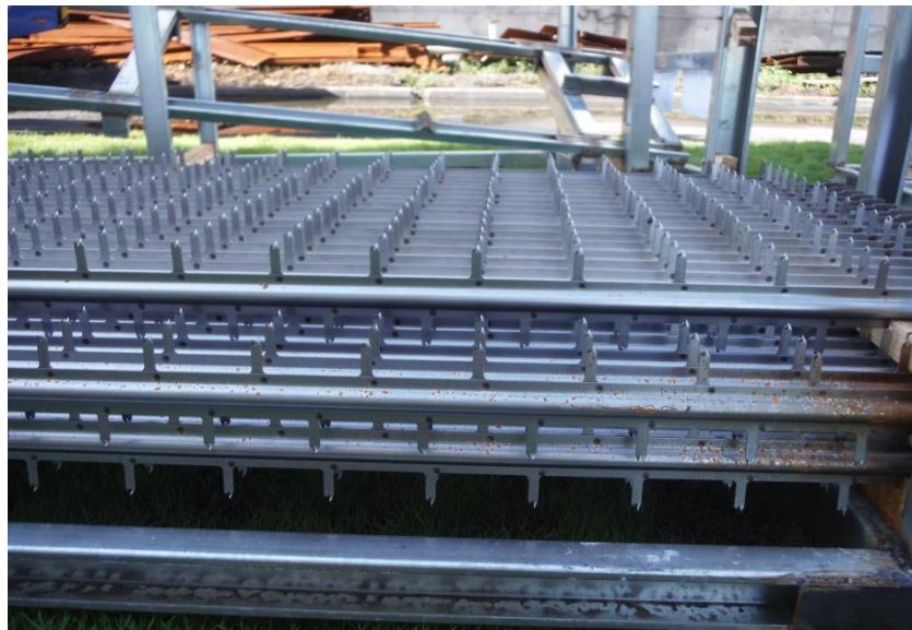
รูปที่ 10.49 Discharge Electrode ที่ปรับปรุงใหม่
