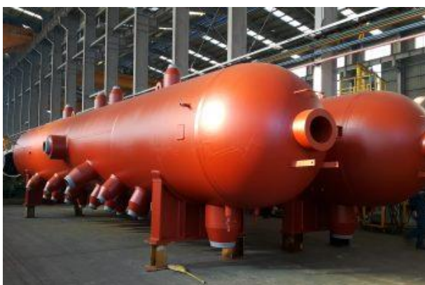
รูปที่ 4.4 ถังพักไอน้ำ (Steam Drum)
