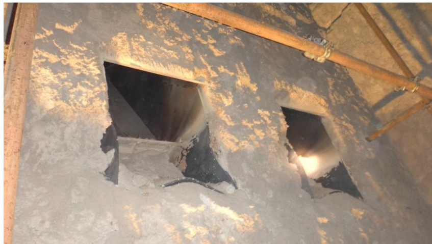
รูปที่ 10.22 ช่องป้อนเชื้อเพลิงเกิดการ Deform และมีแก๊สอุดตันช่อง Feeding Air
