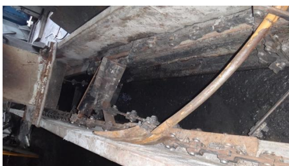
รูปที่ 10.34 การแก้ไข Chain, Flight Bar ของ Wet Ash Chain Conveyor ที่ชำรุด
