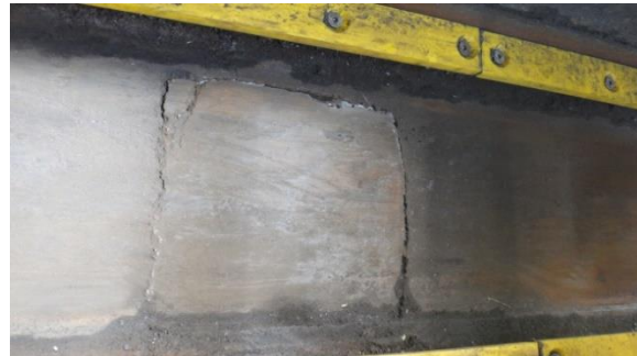
รูปที่ 10.36 การแก้ไข Conveyor Casing, Chain และ รางรับสายพาน ที่ชำรุดสึกเสียหาย
